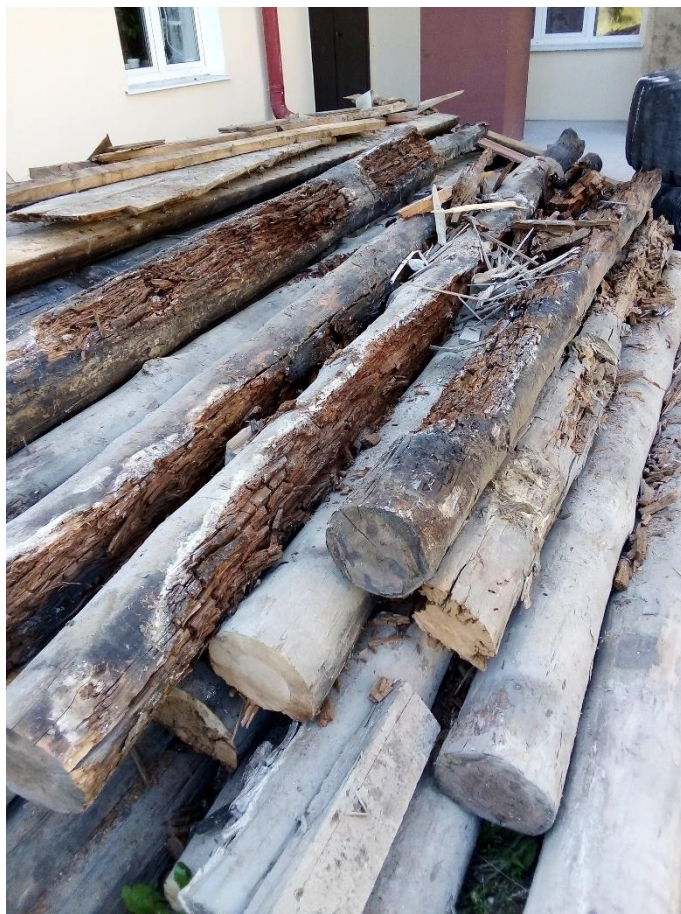
Фото 39. Демонтированные конструкции пола (фото 2019 года, предоставлено работниками дворца)
